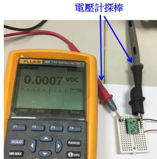
圖 5.7、鋰離子電池電源 PowerSiM EN pin 接 GND，電壓輸出 0V(Vin 輸入)
